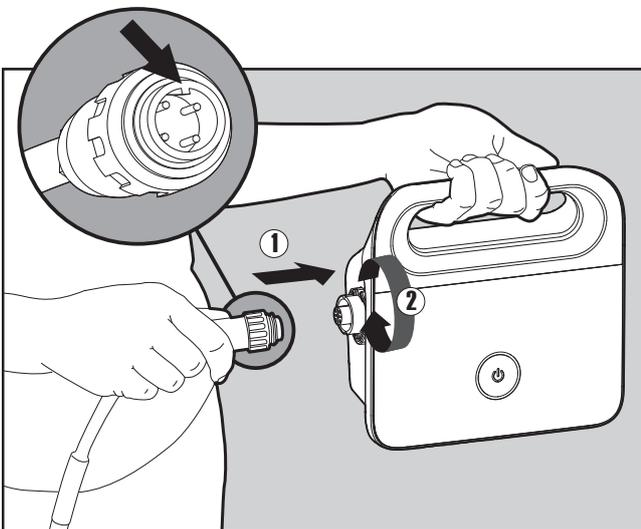
**5.1.3** Conecte el cable flotante a la fuente de alimentación insertándolo con la lengüeta en el conector (1), alineándolo con la ranura en la toma del suministro eléctrico, y girándolo en el sentido de las agujas del reloj (2).
