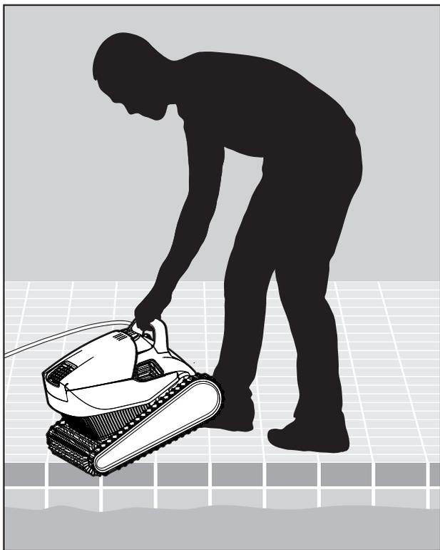
**5.2.1** Coloque el limpiador en la piscina. Suelte el limpiador de piscina y deje que se sumerja en el fondo de la piscina. Asegúrese de que el cable flotante no está obstruido.
