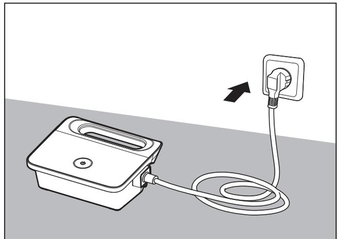
**5.1.4** Enchufe la fuente de alimentación y déjela en la posición OFF (Apagado).
